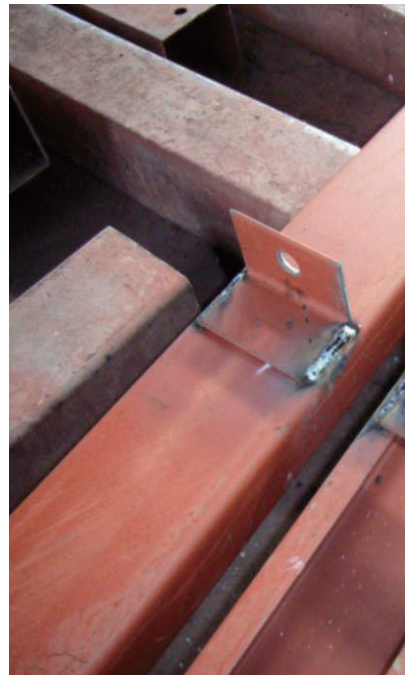
アーク溶接により工場内でネコピースを溶接
