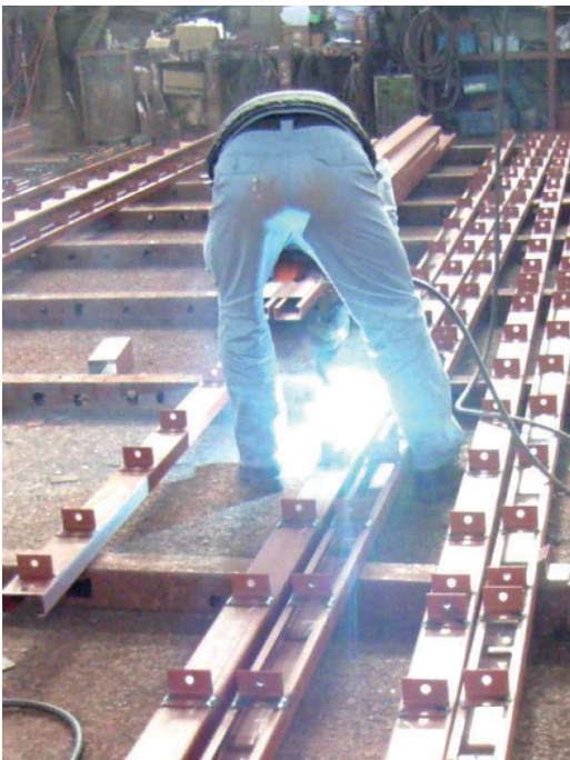
アーク溶接により工場内でネコピースを溶接
